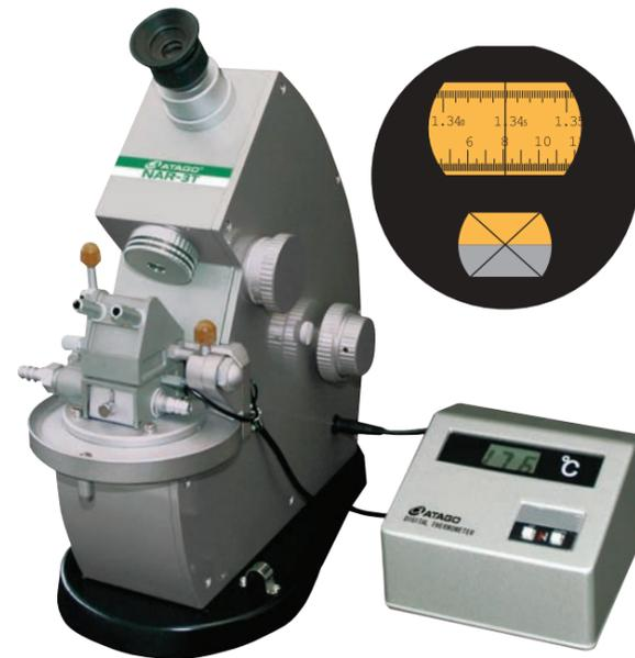
アッペ屈折計の中で最も精度の高いモデルです。大きく見やすい境界線と大型目盛板で屈折率目盛が0.00005まで読み取ることができます。サンプルの着色度や光の透過率に応じて、明るさの光量調整が可能で、明るく最適な測定条件が得られます。
