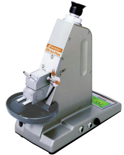
測定値をデジタル表示できるアッベ屈折計として開発されたモデルです。大きく見やすい屈折視野を採用し、測定値は大型の液晶により、屈折率またはBrixの測定値が自動表示されますので目盛を読み取る必要はありません。水でのゼロ合わせはクロス線を合わせてスイッチを押すだけで、とても簡単です。プリンター(オプション)またはパソコンへの接続が可能です。
