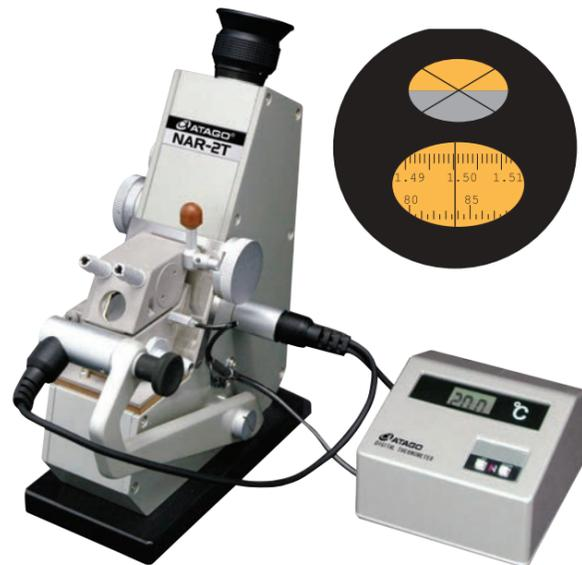
5~120°Cでの測定が可能で、融点が常温より高い物質や、120°C以下に転移点を有する物質の測定に有効です。液体サンプルの他、ガラス、フィルム、プラスチックなどの固体サンプルの測定も可能です。
