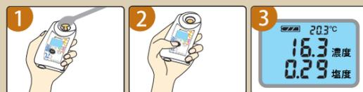
採取しただしやつゆを プリズム面に1滴たらしめます。 STARTキーを押します。 測定値と測定時の温度が デジタル表示されます。
